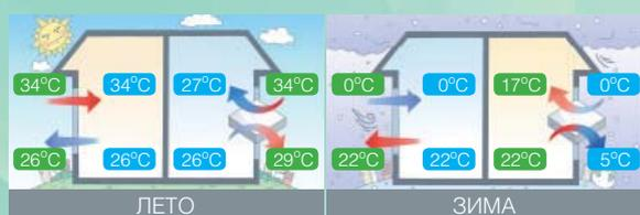
При естественной вентиляции (при открытом окне) температура воздуха на улице влияет на температуру в помещении и происходит потеря энергии. Система ERV обеспечивает аналогичный эффект вентиляции, но при этом поддерживает желаемую температуру в помещении.
