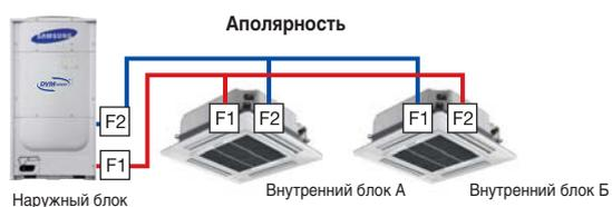
Нормальная работа даже в случае неправильного подключения соединительных кабелей
